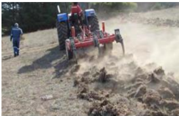
Gráfico 15. Labor de subsolado Centro Experimental Hidango, Instituto de Investigaciones Agropecuarias (INIA)
