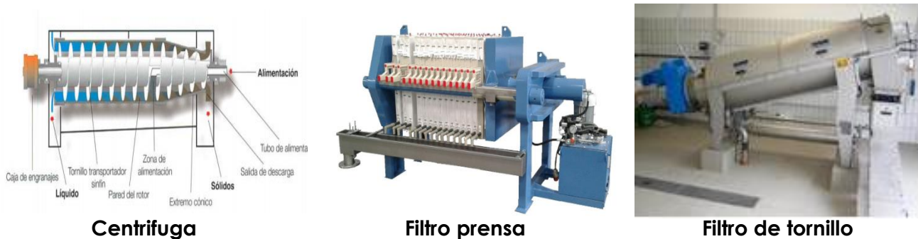
Gráfico 60. Deshidratadores mecánicos de lodos
